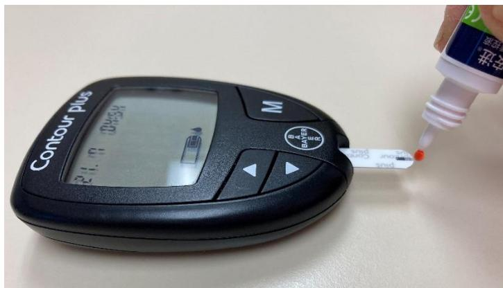
將監控液水滴靠近試紙末端，請避免直接接觸監控液樽尖端，以防止污染。
